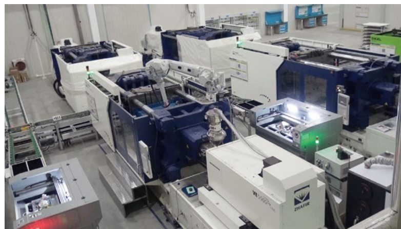
机器人上侧取件、激光切割、双层流水线
